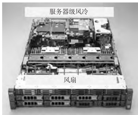
图 2.2-4 服务器级风冷示意
