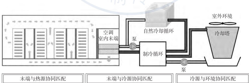
图 2.1-1 数据中心典型冷却系统构成
