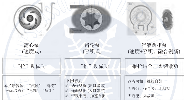
图 5.2-1 SDP 系列汽液两相制冷剂泵原理图
