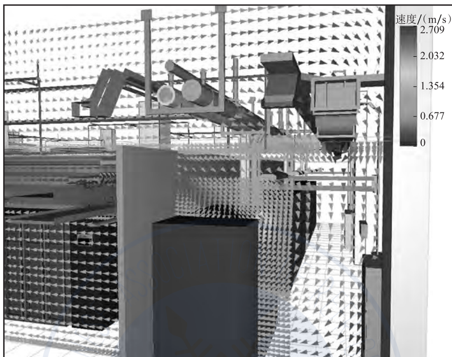
图 3.4-5 利用 CFD 技术模拟局部气流组织
