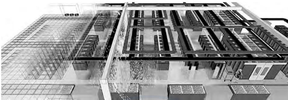
图 4.4-2 机房 CFD 模拟图
