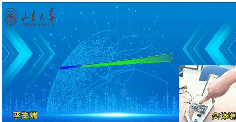
图 2 仿真数据驱动的悬臂梁“数字-力学”孪生模型
