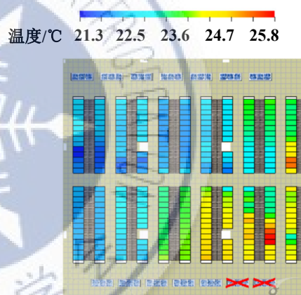
图77 同侧空调关闭
