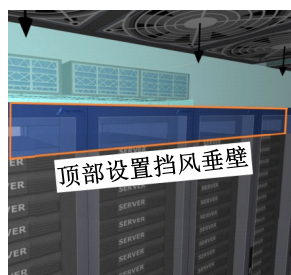
图 40 机柜顶部挡风垂壁安装
