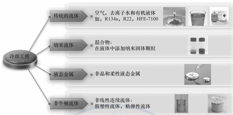
图 2.6-2 微通道流动常见冷却工质
