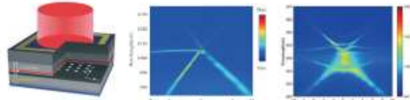
光子晶体激光器 (PCSEL) 的荧光特性
