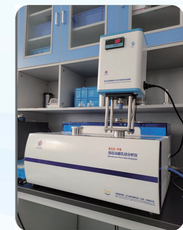
覆压式燃料电池碳纸横向气体扩散性能测试
