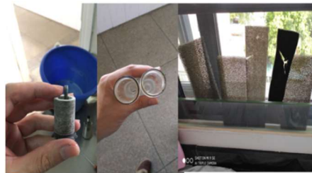
图4 定期清洗更换水汽分离器滤芯、过滤网
