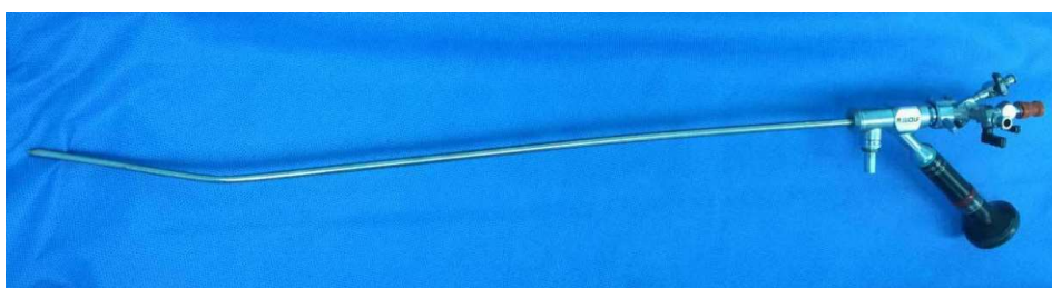
图 7 外管弯曲变形 (序列号无法辨识)
