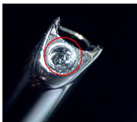
图 2 物镜损害（SN5000329848）
