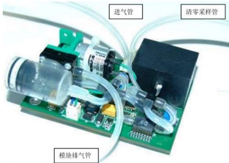
图6 C200型呼吸末CO 2 模块
