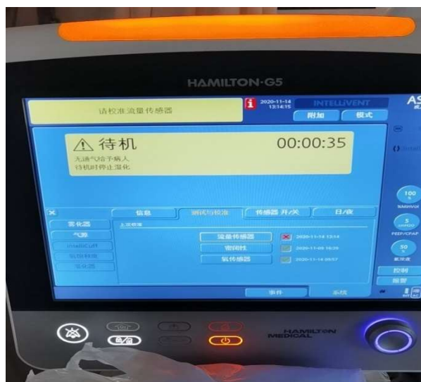
图1 流量传感器报警示意图
