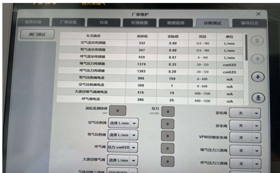
图2.2.2呼吸机阀门诊断图
