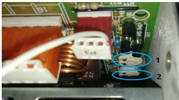
图 6 电源模块可调电压电阻
