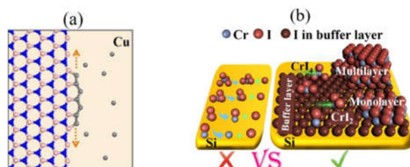
图 1. (a) 石墨烯在 h -BN 边缘异质外延生长的示意图；(b) \text{CrI}_3 单层在 Si 衬底上的生长示意图。
