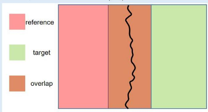
图4 切缝算法
