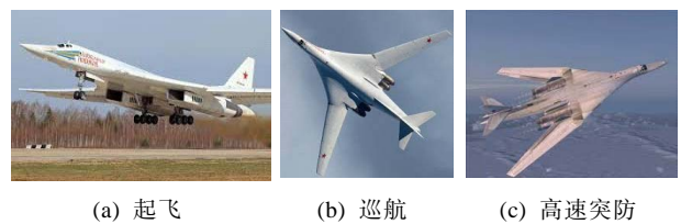
图4 Tu-160飞机不同场景下采用不同的后掠角
