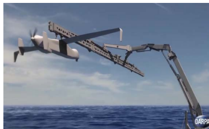
图 2 SideArm 系统 Fig. 2 SideArm System
