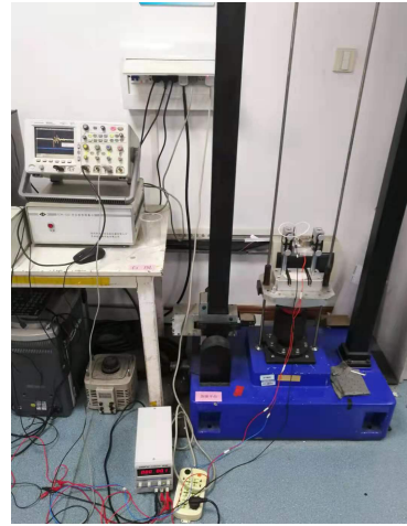
图 9 带有二次冲击的落锤测试系统
