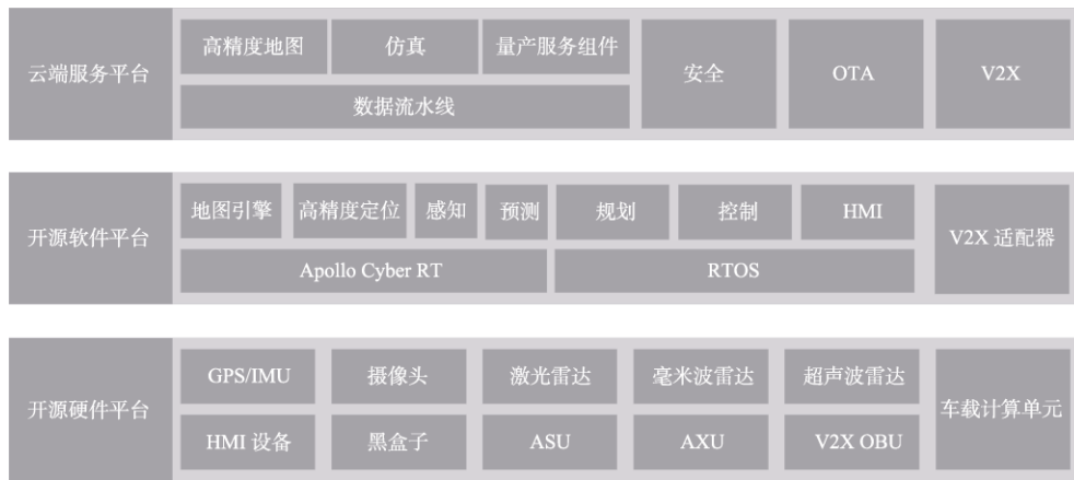
图 21 百度 Apollo 平台架构 [100] Fig. 21 Structure of Baidu Apollo platform
