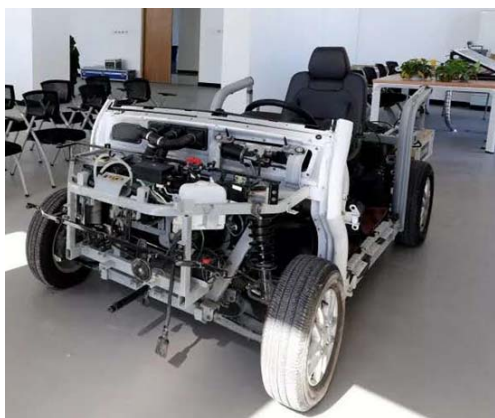
图 19 实车线控底盘
