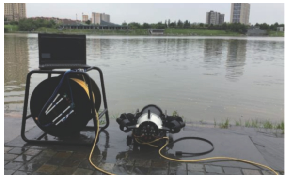
图1 水下机器人探测系统组成图
