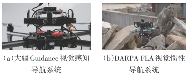
图5 无人机视觉导航技术的应用 Fig. 5 Application of UAV visual-based navigation
