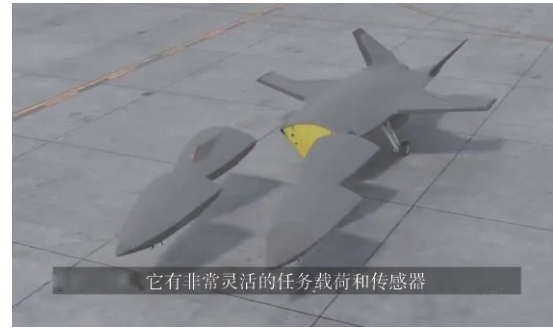
图3 空中力量编组系统无人机更换机头示意图
