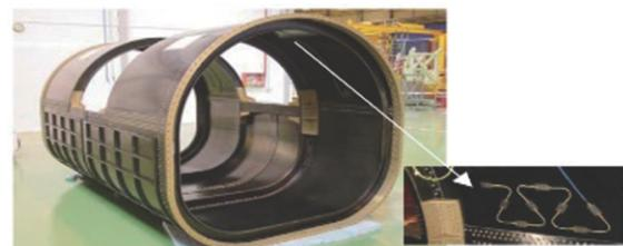
图4 航天器返回舱光纤光栅传感器系统<sup>[21]</sup>
