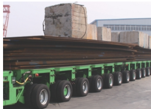
图9 自行式模块车编队运输 Fig. 9 Module car formation transportation
