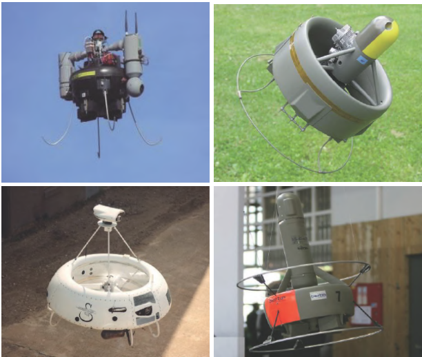
图7 微小型涵道风扇式飞行器：霍尼韦尔公司研制的MAV（左上）；iSTAR（右上）；Cypher（左下）；Hovereye（右下）
