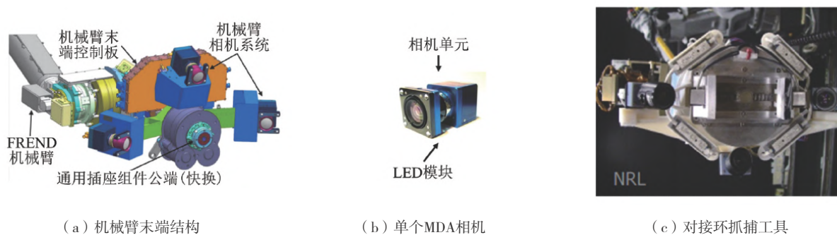
图6 FRENDD机械臂末端结构及对接环抓捕工具
