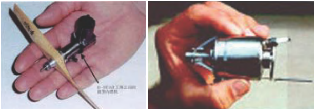
图19 D-STAR公司的微型内燃机(左)与斯坦福大学的微型涡轮发动机(右)
