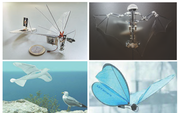
图4 具备自主飞行能力的微小型扑翼飞行器：DelFly Explorer（左上）；Bat Bot（右上）；FESTO公司的仿生鸟（左下）与仿生蝴蝶（右下）
