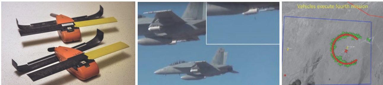
图11 灰山鹑微小型无人机(左); F/A-18F战斗机投放灰山鹑(中); 地面站显示正在执行任务的灰山鹑无人机集群(右)
