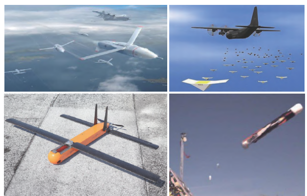
图10 无人机编队协同作战构想图（左上）；采用轰炸机投放大量小精灵无人机（右上）；折叠展开后的蝉微小型无人机（左下）；筒式发射的北美狼袖珍无人机（右下）
