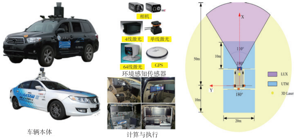
图1 无人车的硬件系统组成：车辆本体、环境感知传感器、计算与执行。此图由文献 [3] 修改而成
