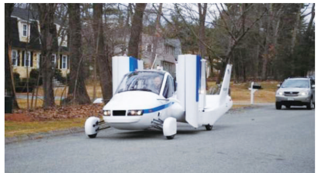
图6 Transition飞行形态和折叠形态
