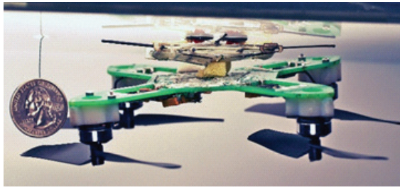
图12 旋翼仿生足式栖息装置
