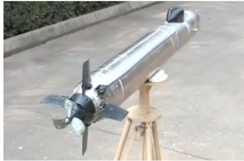
图2 外国侦察型缆控水下机器人
