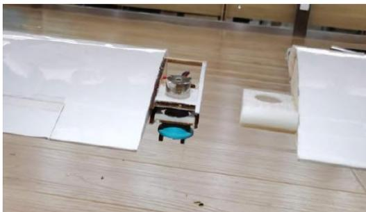
(b) 翼尖连接机构
