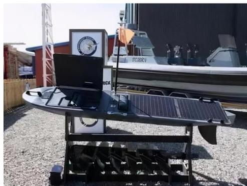
图4 液体机器人公司研制的波浪能滑翔器
