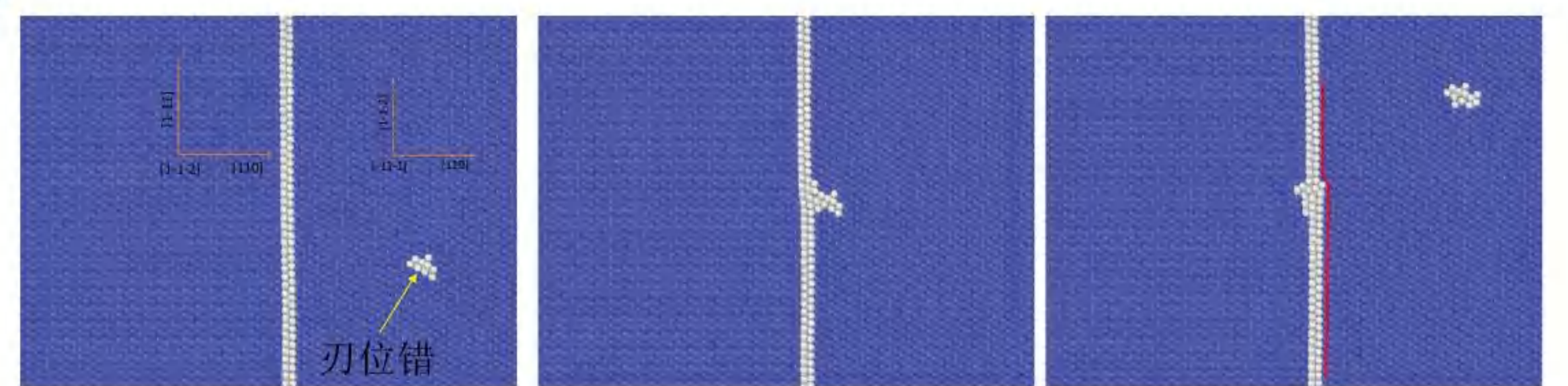
图5 阶梯状晶界的形成机制
