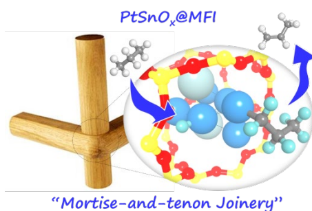
图 1. MFI 分子筛封装亚纳米 PtSnO x 团簇结构示意图。
