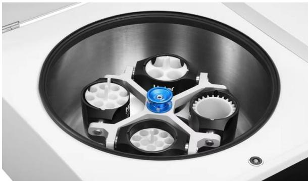
LX-155T500R为台式多功能冷冻离心机，最大容量为4\*500ml，最高转速15500rpm，最大离心力26322xg，适配0.2ml、0.5ml、1.5ml、2ml、5ml、7ml、10ml、15ml、50ml、100ml、250ml、500ml常用离心管/瓶；
