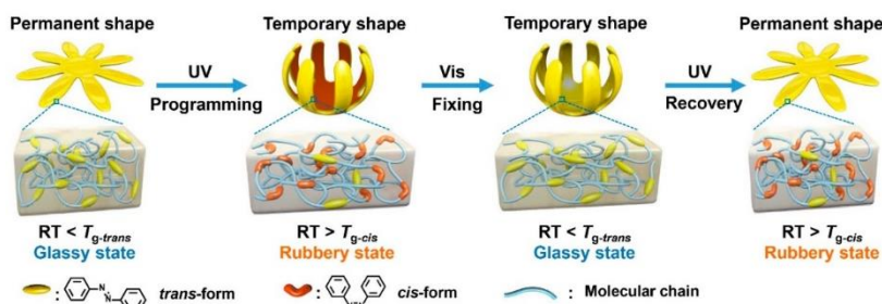
图 1. 偶氮苯液晶高分子网络的无热形状记忆效应过程与机理
