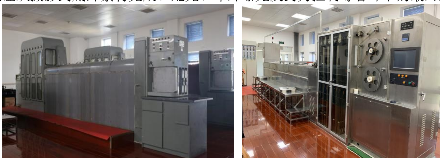
图 5 4401 黑白底片洗片机和申贝彩色正片洗片机
