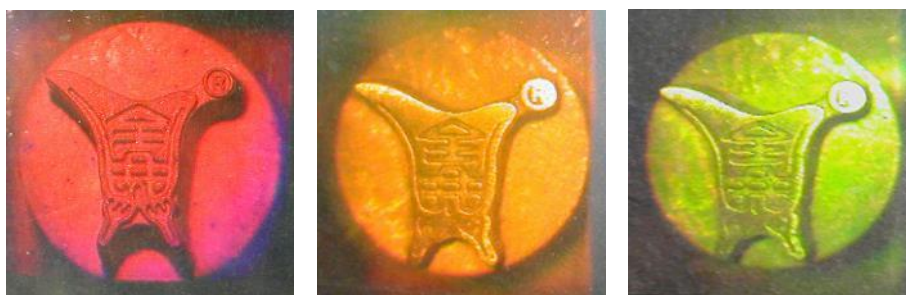
图4 采用波长调节技术记录的反射全息图的三维再现图像
