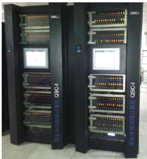
图 D.2 喷淋式蒸发冷却计算机
