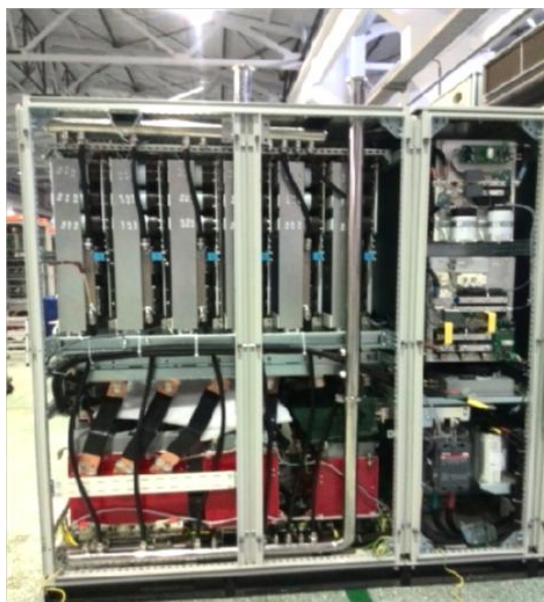
图 E. 2 表贴式蒸发冷却变流器
